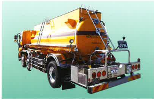
耐ケミカルテフロンライニングローリー車 タンク内部にテフロンをコーティングしたローリー。濃硫酸、弗酸、硝酸系の超強酸の廃棄物輸送を目的とする。真空ポンプによる吸引、圧送が可能。
