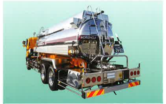
ステンレスローリー車 主に苛性ソーダや尿素水等、化成品の輸送に使用。また「廃アルカリ」、「汚泥」等の廃液の輸送が可能。
