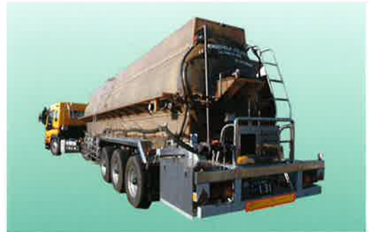
FPRセミトレーラー車 25tセミトレーラー。化成品を輸送するセミトレーラー。
