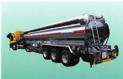
廃油輸送ステンレスセミトレーラー車 25t廃油トレーラー車。低引火点の廃油。廃溶剤などを輸送する危険物対応のセミトレーラー車。(油種別の積分けが可能)
