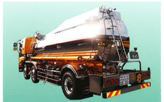
廃油輸送保温ローリー車 ラジエーターの温水を利用しタンク内の温度を下げることなく、低温度で固化する廃油などの輸送を可能にしました。
