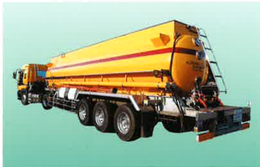
耐ケミカルテフロンライニングセミトレーラー車(2槽式) 22tテフロンライニングセミトレーラー。タンク内部が2槽式のため、2種類の液の輸送が可能。(11t×2槽)
